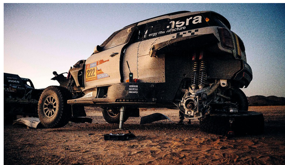
■ C'est le roulement à l'arrière-gauche qui a provoqué le décrochage de Guillaume de Mévius au classement du Dakar. © SIMON BAUCHAU
