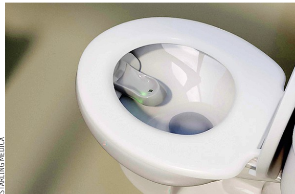
Chez Starling Medica, un appareil qui se fixe dans la cuvette des WC pour tester automatiquement l'urine et vérifier que la personne n'a pas d'infection des voies urinaires.
